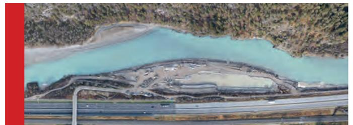
*Bauarbeiten im mittleren Teil der Renaturierungsmaßnahme auf Höhe Thannrain: ca. 650 m langer Abschnitt mit Aufweitung.*
